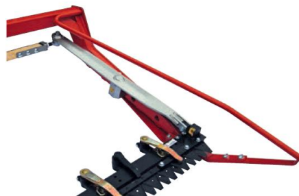
Stranový pohon portálového žacího ústrojí.
